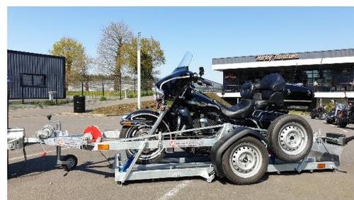
**REMORQUE CCL8** pour 2 motos – chargement à plat 100% au sol, charge utile 500 kilogrammes.
