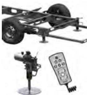
Le nouveau système de nivellement hydraulique innovant permet de stabiliser simplement un camping-car (jusqu'à 6t) en toute sécurité à l'aide d'une télécommande intuitive, en moins d'une minute. Le poids est réparti de façon idéale grâce à 4 unités hydrauliques indépendantes placées directement sur le châssis. C'est une solution optimisée pour éviter de condamner un espace de rangement et réutilisable en cas de changement de véhicule.
